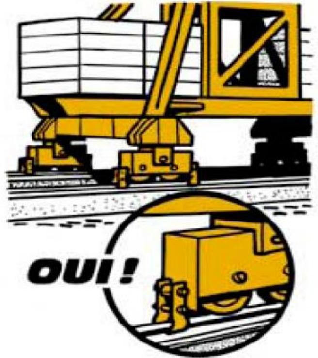
**Art. 30.** - Un espace libre de 60 centimètres au moins doit être ménagé entre les obstacles fixes et les pièces les plus saillantes d'un appareil circulant sur une voie de roulement.
