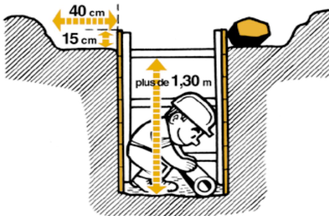
**Art. 72.** - Afin d'empêcher les chutes de déblais, de matériaux, d'outils ou d'objets de toute nature à l'intérieur des fouilles en tranchée de plus de 1,30 m de profondeur, celles-ci doivent être entourées de plinthes d'une hauteur de 15 centimètres au moins ou comporter un blindage dont les éléments constitutifs dépassent le niveau du sol d'une hauteur minimale de 15 centimètres.
