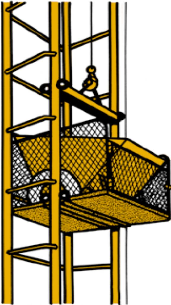
**Art. 36.** - Le chariot de guidage d'un monte-matériaux doit être muni d'un dispositif-parachute capable d'arrêter, en cas de rupture du câble de levage, la chute du plateau.
